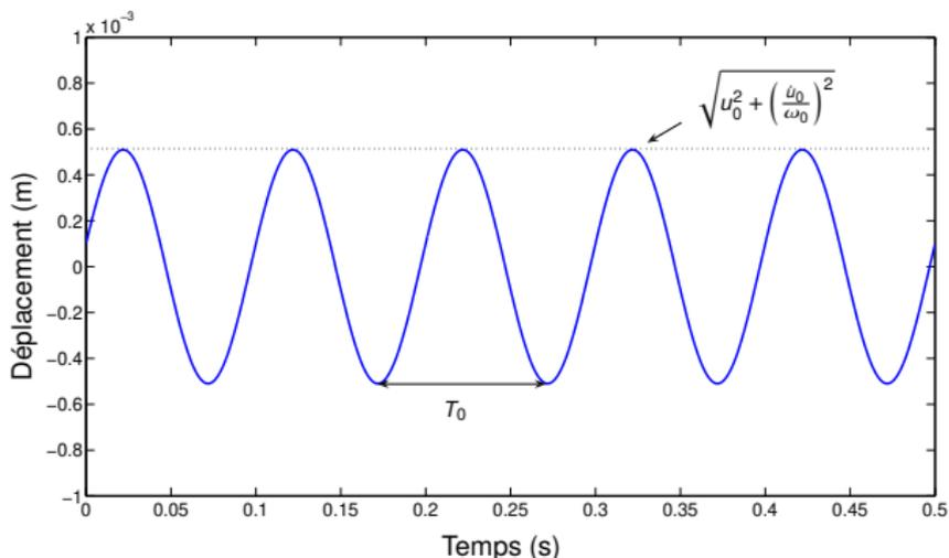
**Figure 1.3-** Vibrations libres d'un oscillateur  $(m, k)$  soumis aux conditions initiales  $u(t=0) = u_0$  et  $\dot{u}(t=0) = \dot{u}_0$ .
