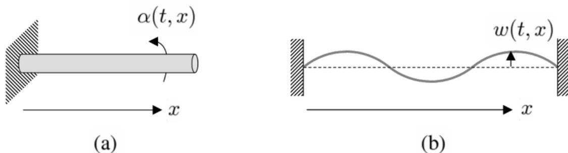
**Figure 3.7-** Problèmes de vibrations analogues à celui d'une barre : (a) torsion d'un arbre cylindrique ; (b) corde tendue.
