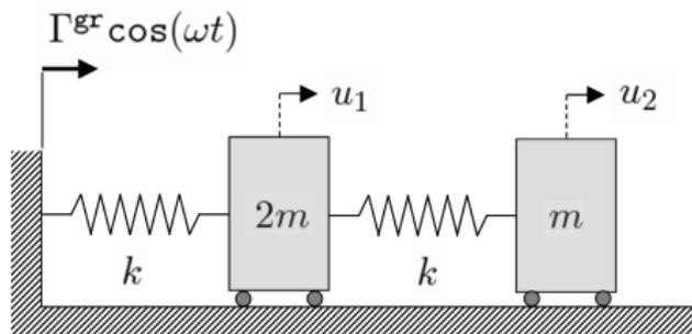
Figure 2.5- Système masses-ressorts excité par accélération imposée.
