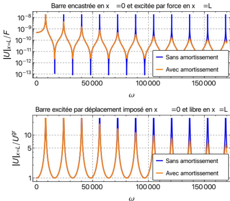
**Figure 3.5-** Évolution fréquentielle du déplacement longitudinal (amplitude) d'une barre encastree en  $x = 0$  et excitee (en haut) par force harmonique en  $x = L$  et (en bas) par déplacement impose en  $x = 0$  et libre en  $x = L$ . Réponse au point d'excitation.
