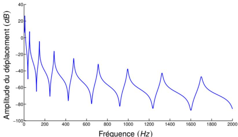
**Figure 3.11-** Évolution fréquentielle (en échelle logarithmique) du déplacement transversal (amplitude) d'une poutre encastree en  $x = 0$  et excitée par force harmonique en  $x = L$  : réponse au point d'excitation.
