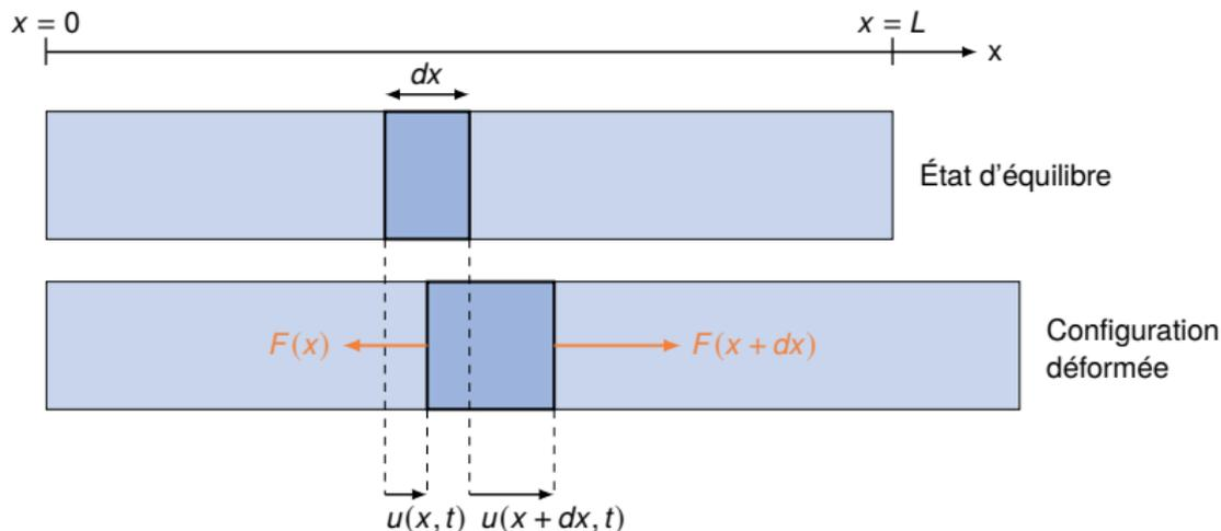
**Figure 3.2-** Illustration d'une barre en traction-compression et équilibre dynamique d'un tronçon de longueur élémentaire  $dx$ .
