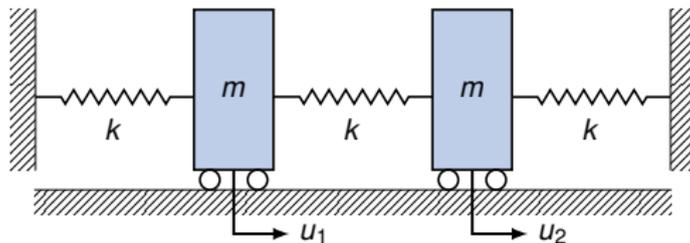
Figure 2.2- Exemple d'un système masses-ressorts à 2 DDLs.
