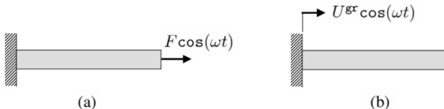
**Figure 3.4-** Vibrations forcées harmoniques d'une barre (traction-compression) : (a) excitation par force imposée ; (b) excitation par déplacement imposé.
