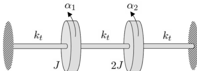
Figure 2.4- Autre exemple de système 2 DDLs, composé de disques rigides massifs et d'arbres de torsion sans masses.
