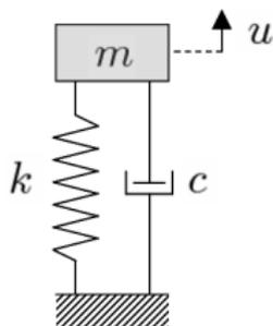
Figure 1.4- Système masse-ressort avec amortisseur visqueux.
