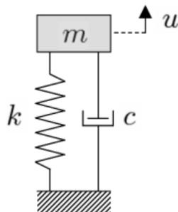
**Principe Fondamental de la dynamique (PFD)** projeté sur l'axe vertical orienté vers le haut :
