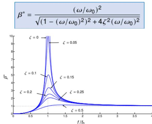
**Figure 1.11-** Variation fréquentielle du coefficient d'amplification dynamique : cas d'une excitation par déplacement imposé.
