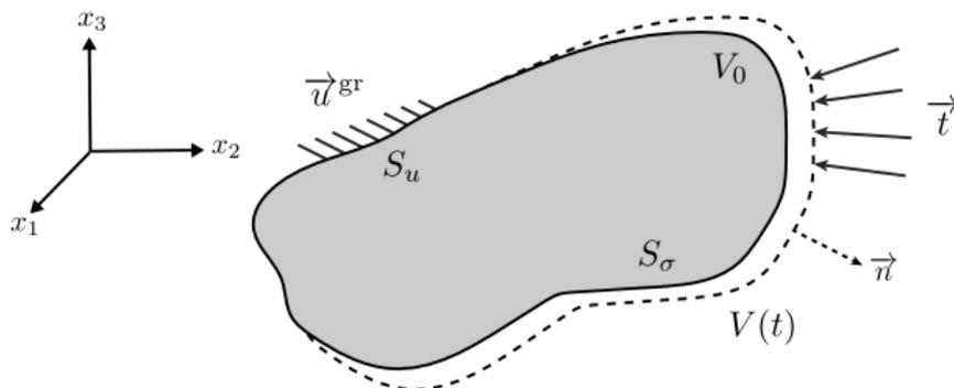
Figure 3.1- Illustration d'un domaine élastique  $V$  de surface  $S = S_u + S_\sigma$ .
