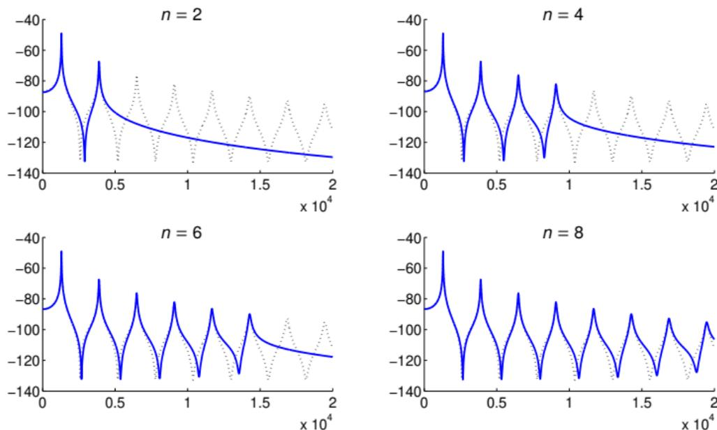
**Figure 3.6-** Évolution fréquentielle du déplacement d'une barre encastée en  $x = 0$  et excitée par force harmonique en  $x = L$  : réponse au point d'excitation obtenue par approche modale.
