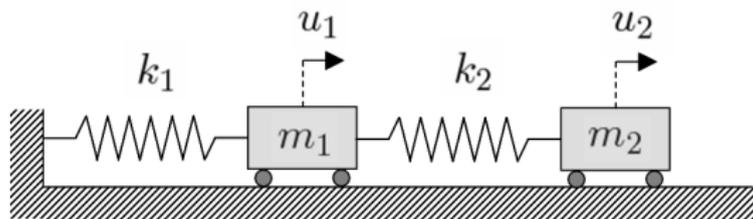
Figure 2.3- Autre exemple de système masses-ressorts à 2 DDLs.
