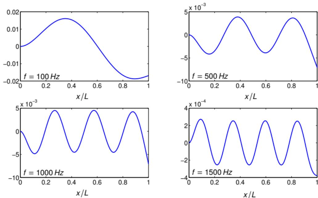
**Figure 3.12-** Évolution spatiale du déplacement ( $\text{Re}[W]$ ) d'une poutre encastée en  $x = 0$  et excitée par force en  $x = L$ .
